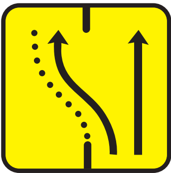
Desvío carril por calzada opuesta, manteniendo otro por obras
