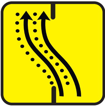
Desvío dos carriles por calzada opuesta
